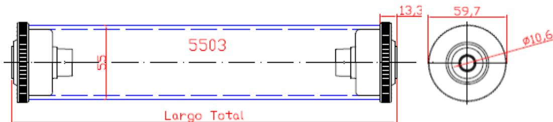
RODILLO DIÁMETRO 55 mm CON BUJES BALONA ESTRIADA CASQUILLO 10 mm CIEGOS
