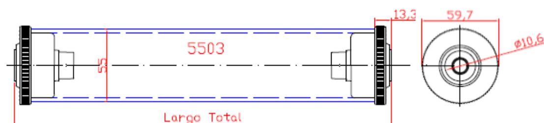
RODILLO DIÁMETRO 55 mm CON BUJES BALONA ESTRIADA CASQUILLO 10 mm CIEGOS COLOR DEL TUBO CREMA Ó AZUL
