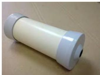
RODILLO DIÁMETRO 55 mm CON BUJES CÓNICOS CASQUILLO 10 mm CIEGO COLOR DEL TUBO CREMA
