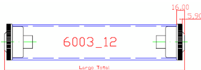
RODILLO DIÁMETRO 60 mm CON BUJES BALONA ESTRIADA CASQUILLO 12 mm CIEGO COLOR DEL TUBO GRIS
