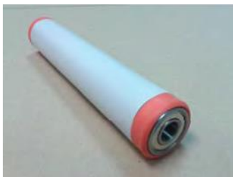
RODILLO DIÁMETRO 30 mm CON BUJES PLANOS RODAMIENTO EJE 10 mm PASANTE COLOR DEL TUBO GRIS
