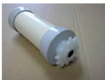
RODILLO DIÁMETRO 55 mm CON BUJE CÓNICO + BUJE CÓNICO PIÑÓN Z-12 P 1/2" CASQUILLO 10mm CIEGO COLOR DEL TUBO CREMA
