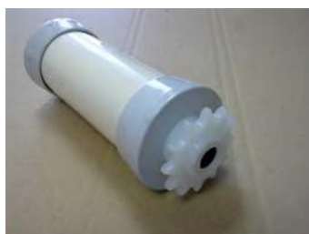
RODILLO DIÁMETRO 55 mm. CON BUJE CÓNICO + BUJE CÓNICO PIÑÓN Z-12 P 1/2" CASQUILLO 10 mm PASANTE COLOR DEL TUBO CREMA
