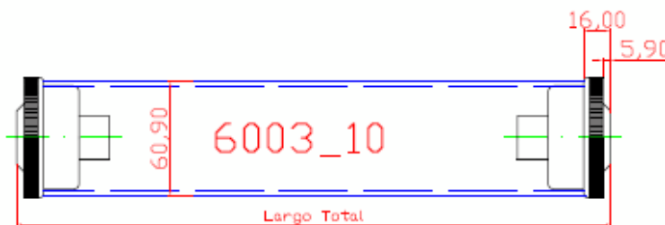
RODILLO DIÁMETRO 60 mm CON BUJES BALONA ESTRIADA CASQUILLO 10 mm CIEGO COLOR DEL TUBO GRIS
