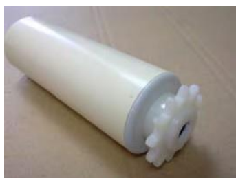
RODILLO DIÁMETRO 55 mm. CON BUJE PLANO BUJE PLANO PIÑÓN Z-12 P 1/2" CASQUILLO 10 mm. PASANTE COLOR DEL TUBO CREMA
