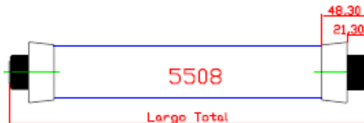
RODILLO DIÁMETRO 55 mm CON BUJES CÓNICOS CORONA, CASQUILLO 10 mm PASANTE COLOR DEL TUBO CREMA
