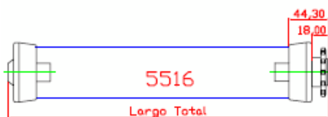
RODILLO DIÁMETRO 55 mm CON BUJE CÓNICO + BUJE CÓNICO PIÑÓN Z-12 P 1/2" CASQUILLO 10mm CIEGO COLOR DEL TUBO CREMA
