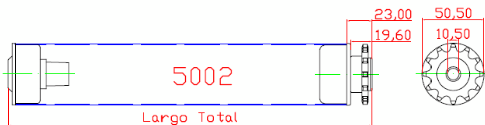
RODILLO DIÁMETRO 50 mm CON BUJE PLANO + BUJE PLANO PIÑÓN Z-12 P 1/2" CASQUILLO 10 mm CIEGO COLOR DEL TUBO CREMA
