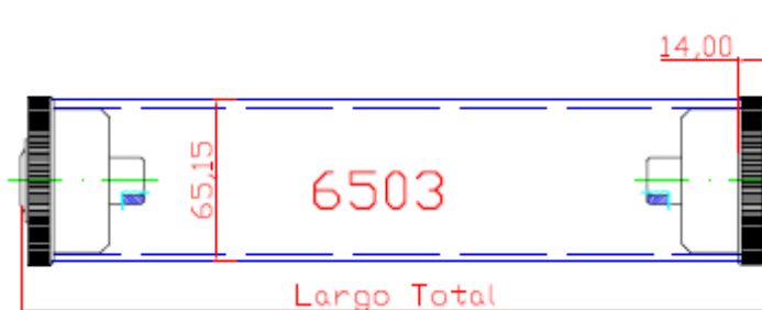
RODILLO DIÁMETRO 65 mm CON BUJES BALONA ESTRIADA CASQUILLO 12 mm CIEGO COLOR DEL TUBO GRIS
