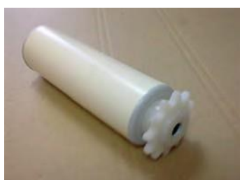
RODILLO DIÁMETRO 50 mm CON BUJE PLANO + BUJE PLANO PIÑÓN Z-12 P 1/2" CASQUILLO 10 mm CIEGO COLOR DEL TUBO CREMA
