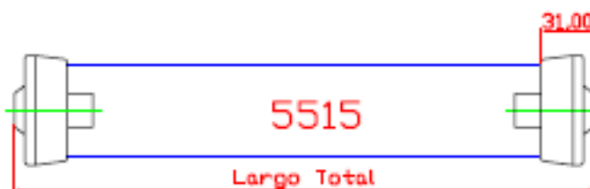
RODILLO DIÁMETRO 55 mm CON BUJES CÓNICOS CASQUILLO 10 mm CIEGO COLOR DEL TUBO CREMA
