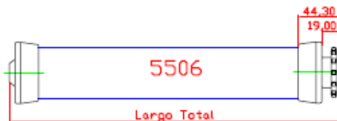
RODILLO DIÁMETRO 55 mm. CON BUJE CÓNICO + BUJE CÓNICO PIÑÓN Z-12 P 1/2" CASQUILLO 10 mm PASANTE COLOR DEL TUBO CREMA
